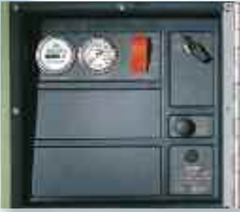
Panel de instrumentos del lado de la acera con SSAM Sistema de apagado y módulo de indicación.
